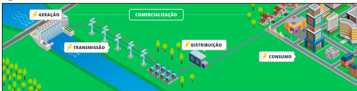
Figura 01: Sistema Elétrico de Potência Brasileiro
